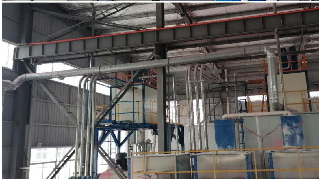
拌料粉尘经封闭拌料房+布袋除尘器+15m 高排气筒有组织排放
